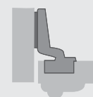
вкладная навеска (База В -3 мм)
