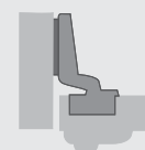
вкладная навеска (База В -3,5 мм)
